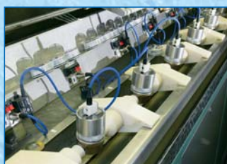
Ověření vodoměrů KADEN na zkušební stanici
