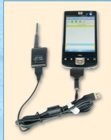
PDA s připojeným USB radiomodulem
